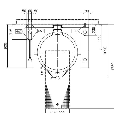
Pentola elettrica basculante, con mescolatore incluso a velocità variabile, 150 lt. (h), carico automatico acqua calda/fredda con rubinetto, doccetta, kit di chiusura posteriore.
